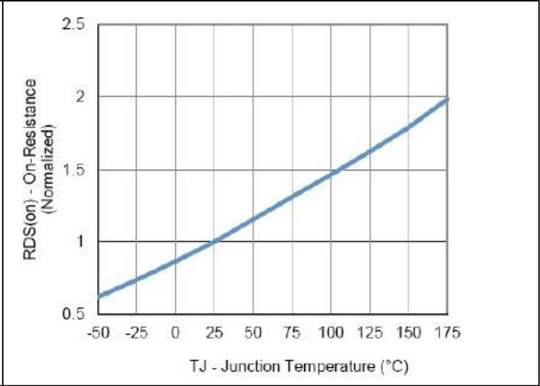
FIG.8-NORMALIZED ON-RESISTANCE VS JUNCTION TEMPERATURE
